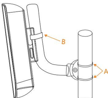
2、先将金属支架A安装在抱杆上，再将主设备安装在金属支架上，用螺丝将B拧紧。
