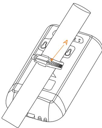
2、将设备安装在抱杆上，用螺丝刀将A部位拧紧。
