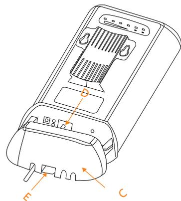
3、按住卡扣E，将设备的盖板C取下，然后将D插入网线，最后将主设备的盖板C扣紧即可。
