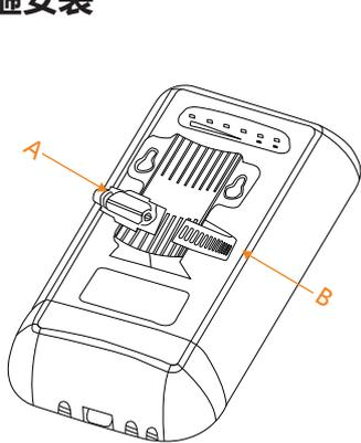
1、先将抱箍A放在产品背面，B安装孔内，可根据抱杆的粗细对安装位置进行调节。
