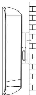
2、将两个钉子钉在墙上，把设备的两个孔位对应钉子挂上就可。
