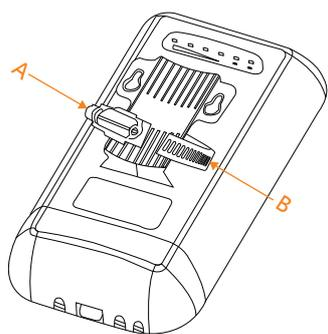
1、先将抱箍A放在产品背面，B安装孔内，可根据抱杆的粗细对安装位置进行调节。
