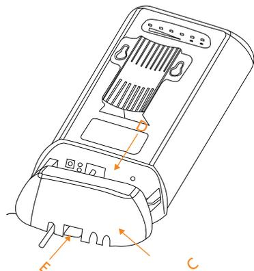
3、按住卡扣E，将设备的盖板C取下，然后将D插入网线，最后将主设备的盖板C扣紧即可。
